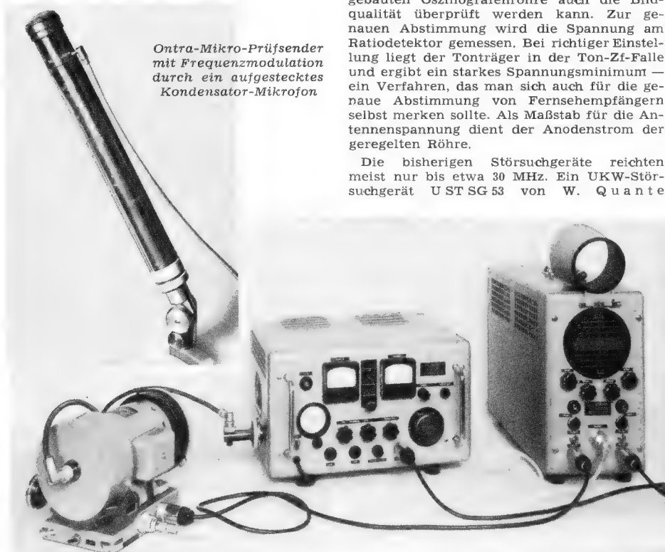
Telefunken-Zentimeterwellen-Meßplatz mit Ringmeßleitung (links), Überlagerungsempfänger (Mitte) und Sichtgerät
