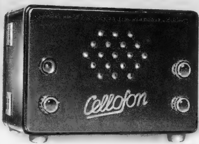
Bild 1. Das erste Modell des Cellofon, eingebaut in ein Isoliergehäuse mit den Abmessungen 120 x 180 x 60 mm
